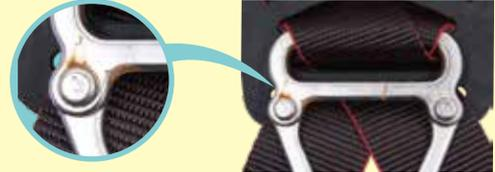
(3) ばねの損傷や異物の混入などでワンタッチバックルのロック解除レバーが元に戻らなかったり、動きがスムーズでないもの
