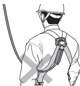
ランヤードが腋にある状態
