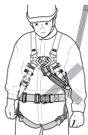
ランヤードが腋にある状態
